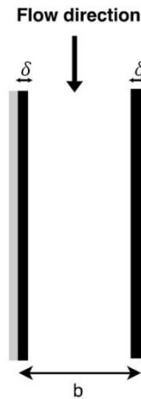
Figur 2.3 – Flöde genom en smutsig rektangulär kanal med ett oändligt sidförhållande. Där \delta är tjockleken på smutslagret och b är avståndet mellan plattorna
